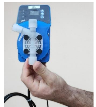
Öffnen der Sicherungsmutter – Sauganschluss
