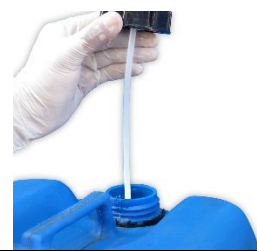
Platzieren des Fußfilters in vertikaler Position im Säurebehälter
