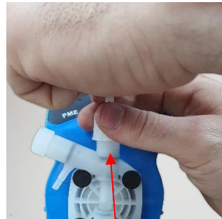
Schließen der Sicherungsmutter und des Sicherungsrings über Schlauch und konische Kupplung
