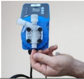
Entfernen der Sicherungsmutter, des Sicherungsrings und der konischen Kupplung
