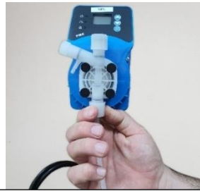
Einsetzen des Saugschlauchs und Schließen der Sicherungsmutter
