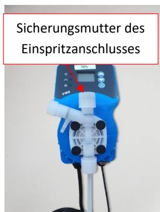
Konische Kupplung, Sicherungsring und Sicherungsmutter entfernt
